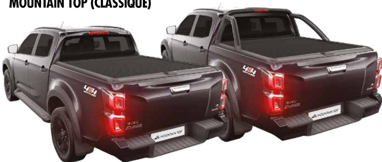
**ROLL TOP COVER / RIDEAU DE BENNE :** Pratique et Esthétique, permet d'ouvrir et fermer rapidement la benne et charger des objets volumineux - Vitesse d'enroulage réglable (+ ou - rapide) - Le rideau peut s'arrêter et se verrouiller sur de multiples positions - Installation simple et sans perçage - Poignée avec serrure intégrée - Fermeture à clé - Permet, une fois ouvert, d'accéder à la benne depuis les 3 côtés – Fabriqué en Aluminium anodisé Résiste aux intempéries et à l'exposition UV –
