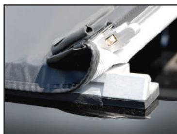
L'ouverture de la bâche se déverrouille par l'intérieur après ouverture du hayon
