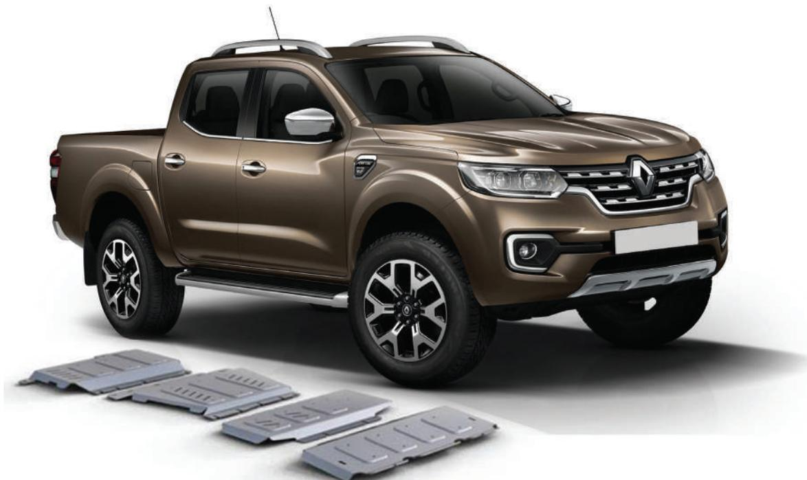
Les protections acier 3 mm offrent une résistance égale à l'aluminium. En cas de choc important, les plaques sont embouties, la protection se déforme afin d'absorber le choc et ainsi limiter l'incidence sur le châssis. Chaque protection Acier est pensée pour répondre à cet aspect technique.
