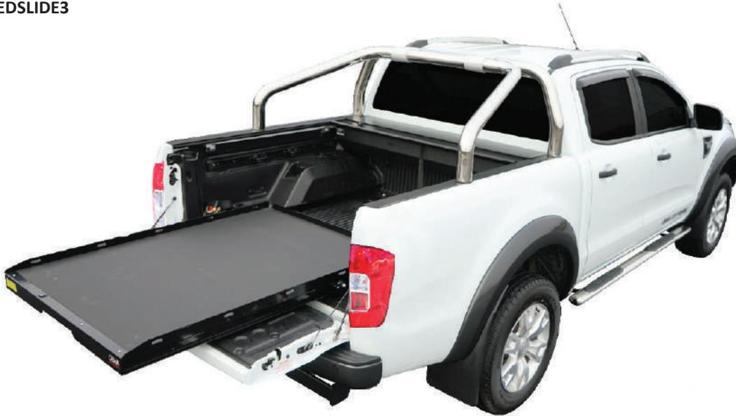
Tout simplement la meilleure façon de charger et décharger le pickup. Grâce à ce plancher coulissant vous pourrez accéder au chargement sans avoir à monter dans la benne. Il est conçu pour charger jusqu'à 600 kg et possède un rebord aluminium avec des points d'ancrage permettant ainsi de sécuriser son contenu. Afin de garantir l'utilisation optimale de ce produit, le bedslide se bloque dans plusieurs positions et possède un sol anti-dérapant qui limite les mouvements du chargement.
