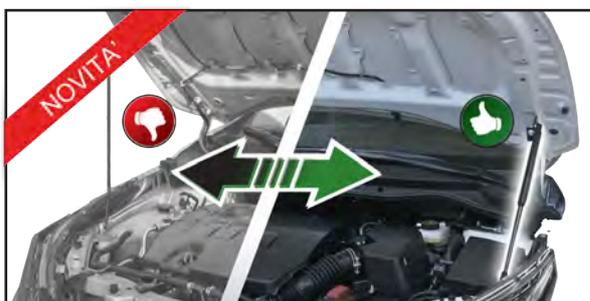
Facilita l'apertura del cofano motore senza più aver necessità dell'asta di sostegno. Il kit s'installa sui punti di fissaggio già esistenti sul veicolo non necessita quindi di alcuna modifica.
