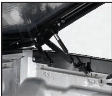
Nuovo sistema di montaggio senza forature.
