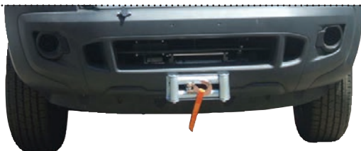
MONTAGGIO CON VERRICELLO A CAVO
