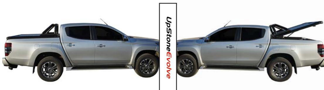
I roll bar specifici per i sistemi UPSTONE EVOLVE si fissano direttamente sul coperchio del tonneau cover. Il sistema esclusivo di cerniere di apertura sviluppato da UPSTONE permette al roll bar di non scontrare l'estremità della cabina quando viene aperto il coperchio.
