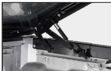
Nuovo sistema di montaggio senza forature.
