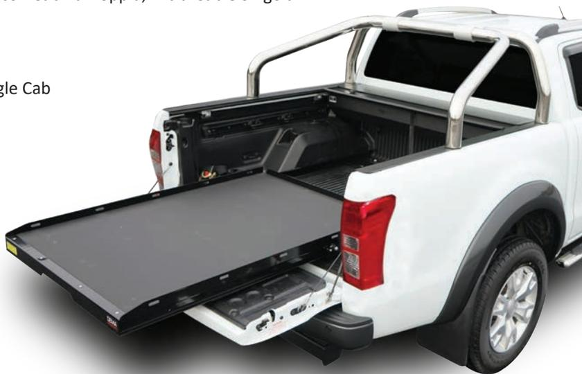
Il pianale è antisdrucciolo per assicurare che il carico non abbia movimenti ed è dotato nel suo perimetro di un bordo in alluminio di circa 10cm come ulteriore sicurezza di carico.
