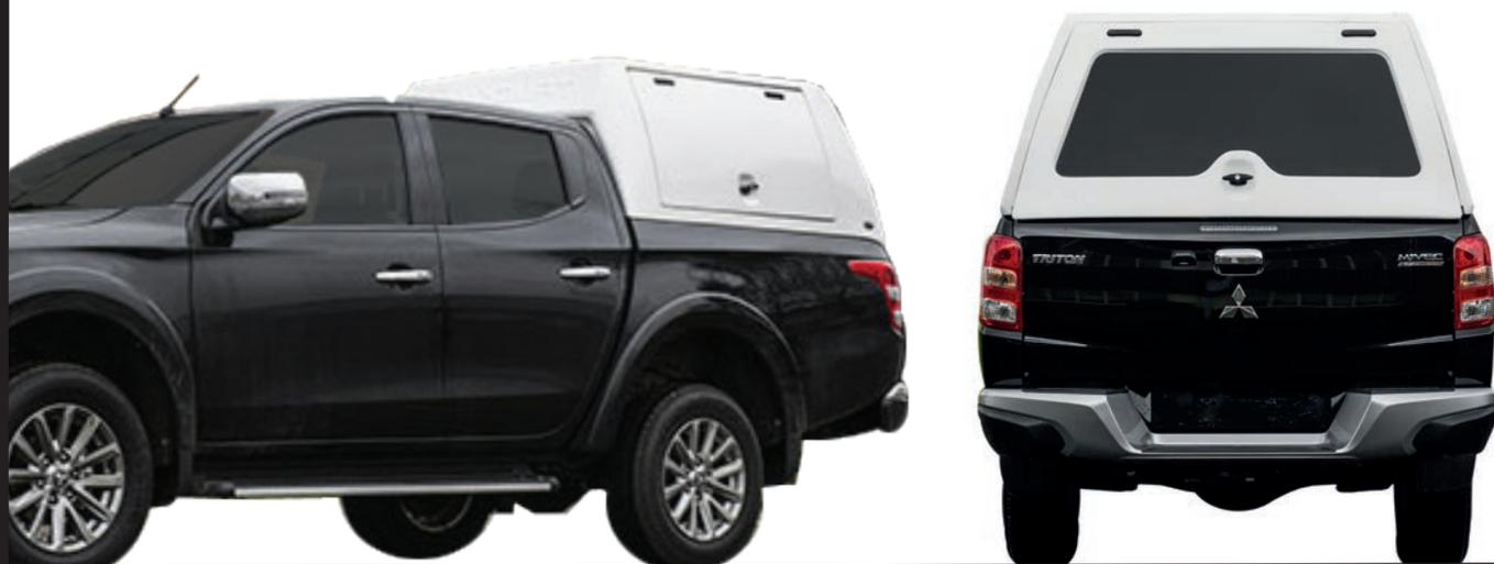
Finitura in Geal Coat liscio - Fabbricazione robusta con rinforzi in acciaio - 4 punti di ancoraggio per fissare colli sul tetto (carico max 100Kg.) - Grande volume di carico - Installazione facile e rapida - Chiusura con serratura a chiave
