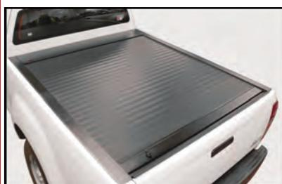
Il ROLL TOP COVER permette di essere regolato nella sua apertura, in modo da rendere possibile il carico di oggetti ingombranti senza dover rimuovere il coperchio. La sua struttura è costituita da lame in alluminio ArmorTek, che garantiscono una lunga durata e la flessibilità anche a temperature estreme.
