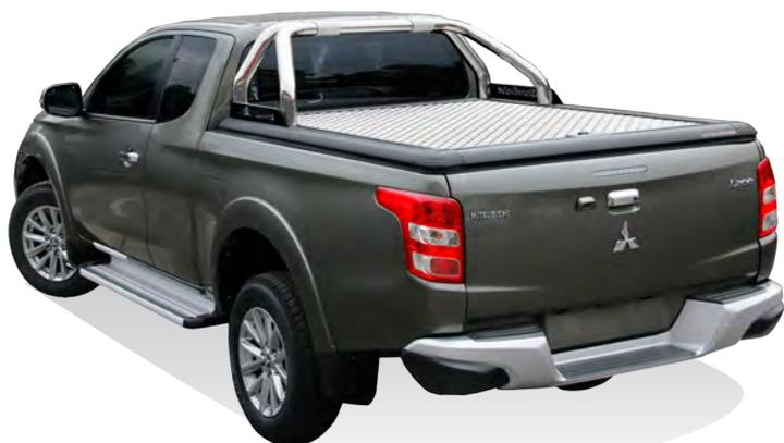
I roll bar specifici per i sistemi UPSTONE EVOLVE si fissano direttamente sul coperchio del tonneau cover.
